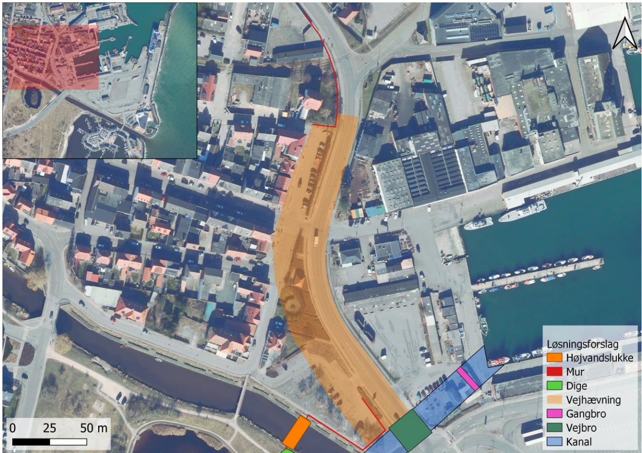
Figur 4.8: Mur og vejhævning ved Kattegatvej.
