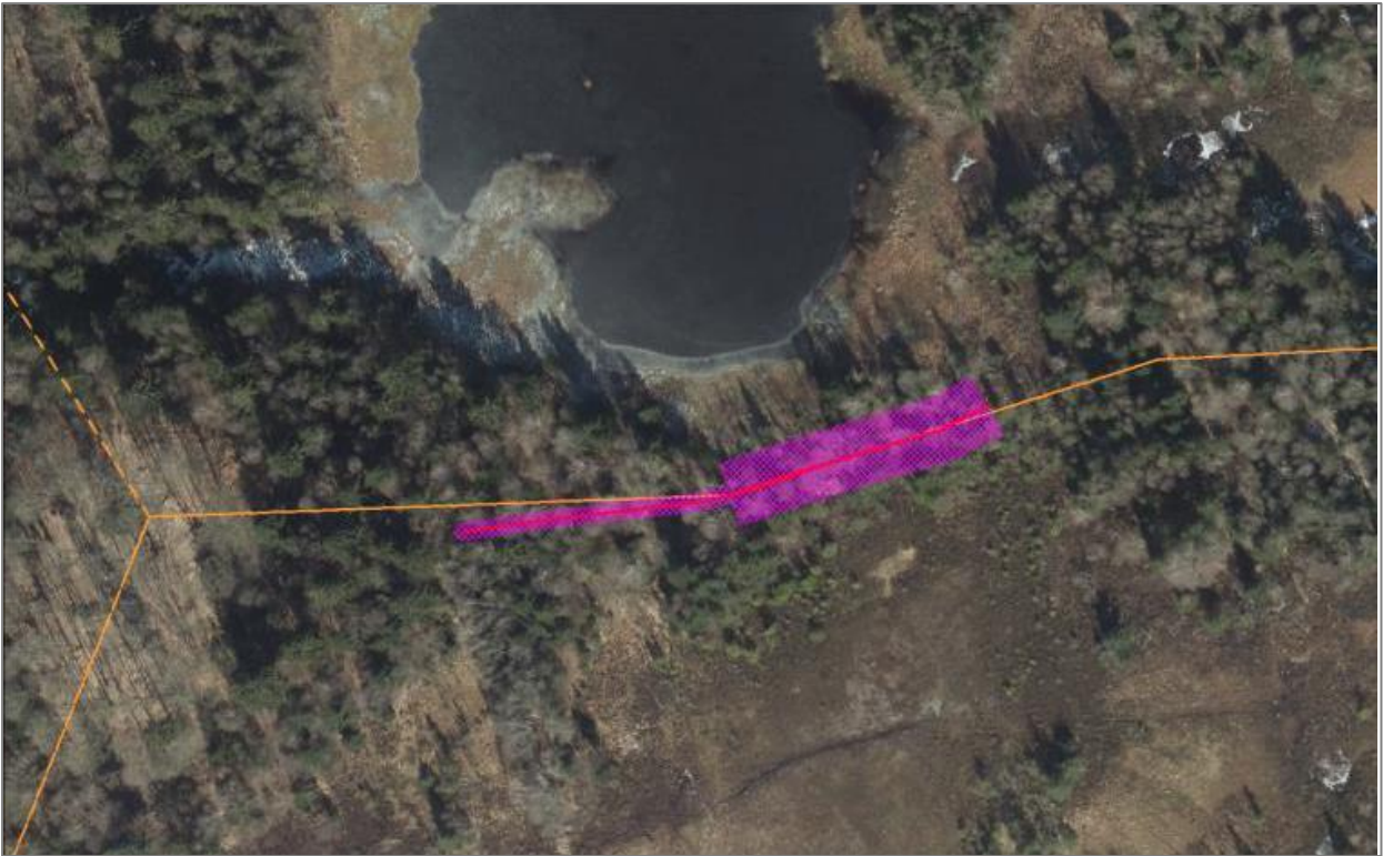
Figur 5. Den etablerede membran (rød streg) mellem delområde 3 og 4. Den orange streg viser afgrænsningen mellem delområde 3 og 4.
