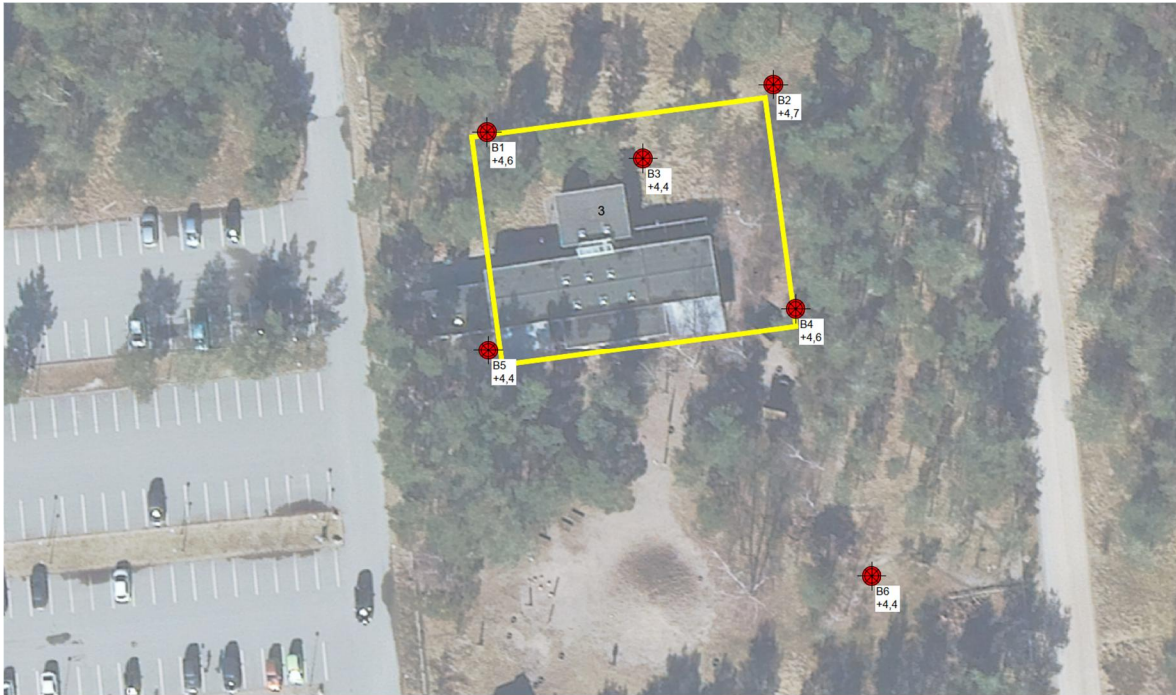
Figur 3-1: Udklip fra geoteknisk rapport med boringsplaceringer.
