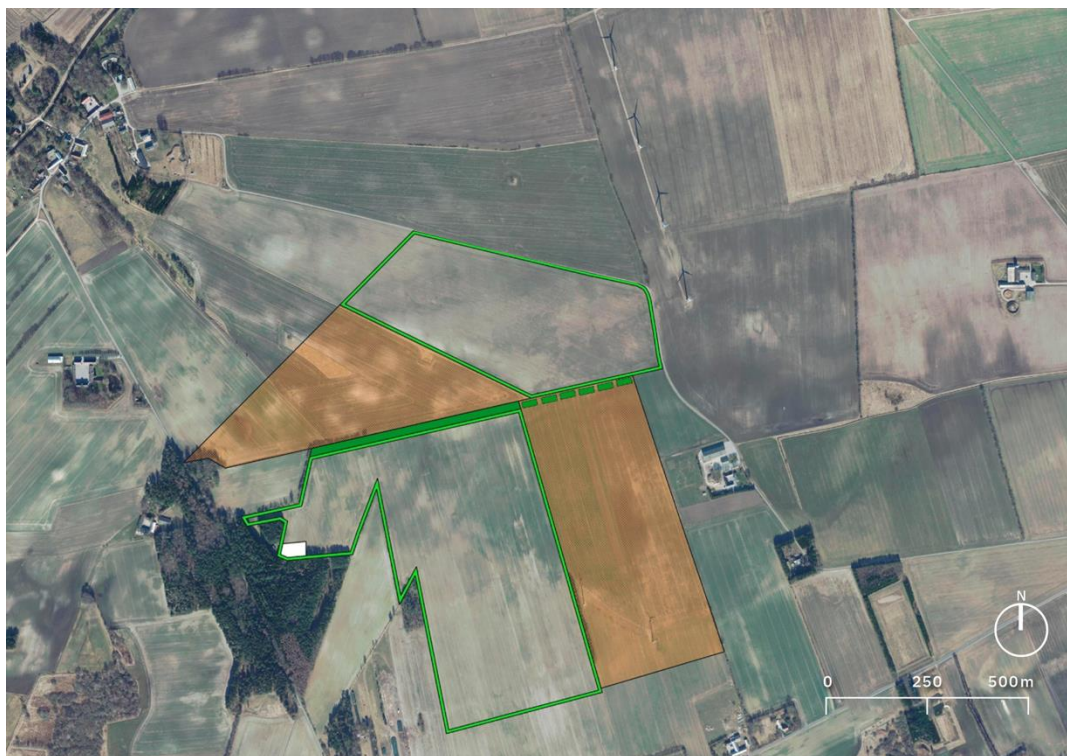
Figur 7.5. Beplantningsbælterne (lysegrøn) rundt om solcelleanlægget vil bestå af både ny og eksisterende beplantning, og transformestationen (hvid) placeres i den vestlige del af plan- og projektområdet. Byggefelterne for Søby 1 (orange) og faunapassagen mellem Søby 1 og 2 (grøn) er også vist.
