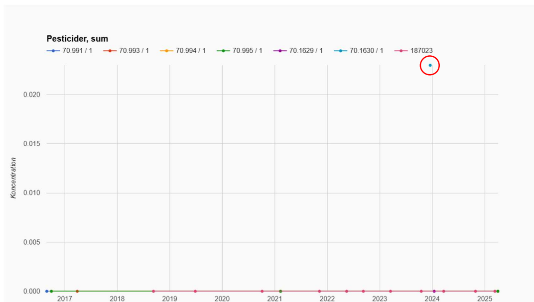
Figur 10.4: Pesticidindhold i indvindingsboringerne (DGU nr. 70.991, 70.993, 70.994, 70.995, 70.1629 og 70.1630) og ved afgang fra vandværket ved Løvenholmskoven (anlægs id 187023). Koncentrationen er angivet i µg/l.
