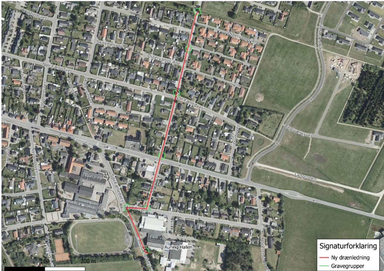
Figur 2.4 Ledningstraceet mellem Auning Hallen og det eksisterende ledningsnet i Østervangs Alle, der leder til det regnvandsbassin, der føder Bjælbæk. © SDFE, WMS-tjeneste, skærmbkort
