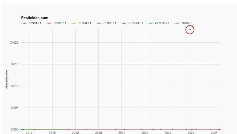
Figur 2.4: Pesticidindhold i indvindingsboringerne (DGU nr. 70.991, 70.993, 70.994, 70.995, 70.1629 og 70.1630) og ved afgang fra vandværket ved Løvenholmskoven (anlægs id 187023). Koncentrationen er angivet i µg/L.
