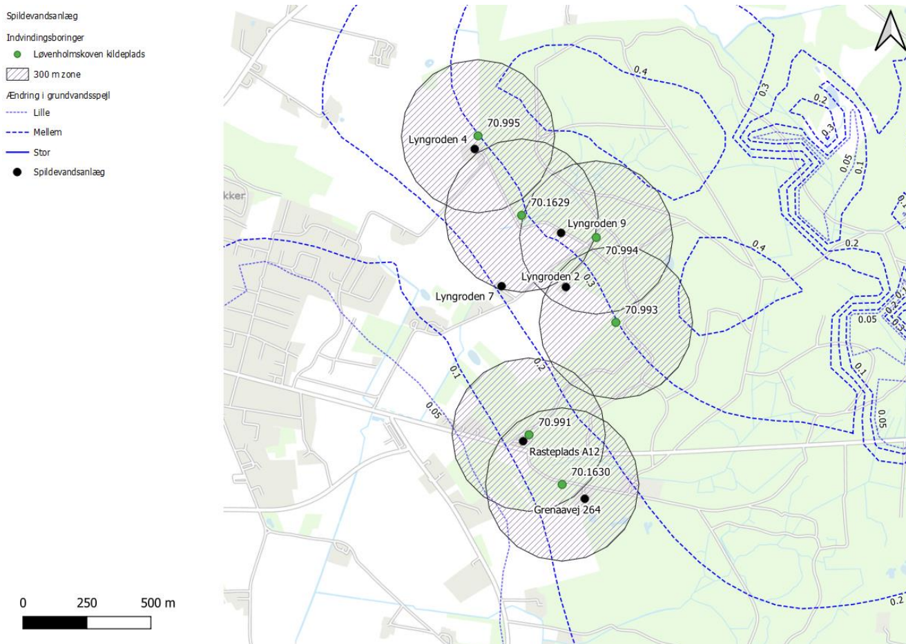
Figur 5.3: Oversigt over ændring i grundvandspotentiale for det øvre sandmagasin (L1), samt påvirkning af spildevandsanlæg nær kildepladsen i Løvenholmskoven.
