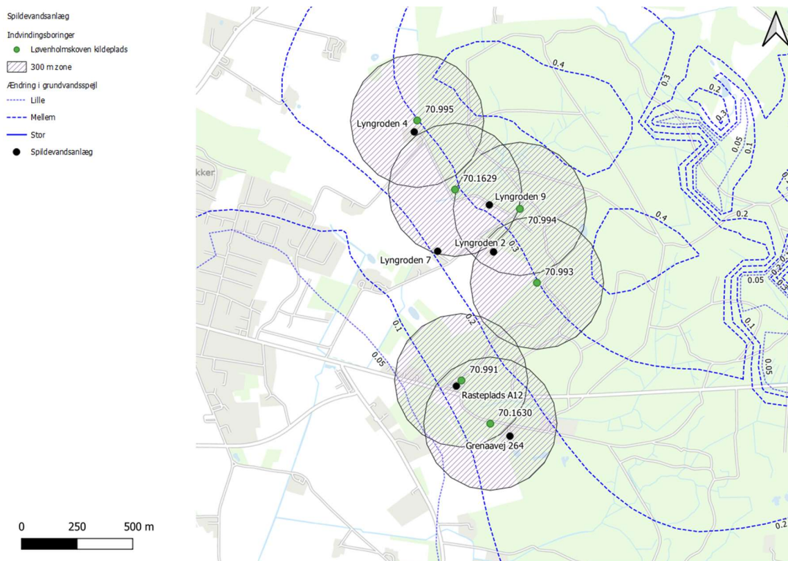
Figur 10.22 Oversigt over ændring i grundvandspotentiale for det øvre sandmagasin (L1), samt påvirkning af spildevandsanlæg nær kildepladsen i Løvenholmskoven. © SDFE, WMS-tjeneste, skærmkort
