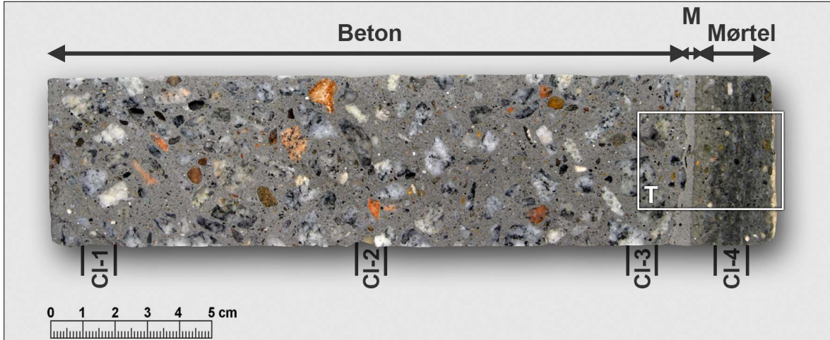
CI-1, CI-2, CI-3 og CI-4: Placering af delprøver for chloridanalyse T: Placering af analyseret tyndslib M: Cementmørtel (membran)
