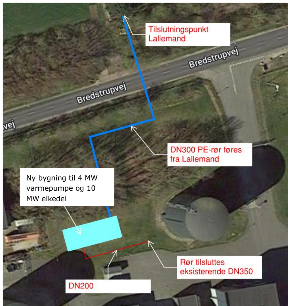
Figur 2: Ledningstracé for fremføring af overskudsvarme til varmepumpeanlægget
