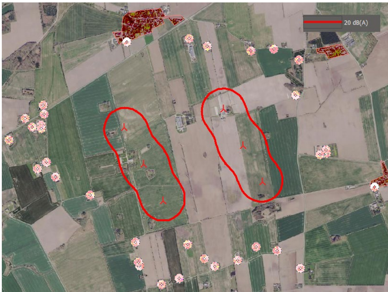
Figur 5-4 Vindmøllernes støjubredelse for lavfrekvent støj ved en vindhastighed på 8 m/s. Beregningspunkter (nærmeste naboer) for støjubredelsen er vist ved markering (stjerne).
