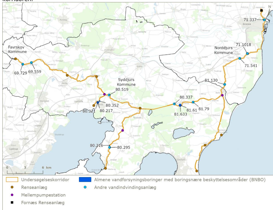
Figur 9-2: Undersøgelseskorridoren samt almene vandforsyningsbøringer og resterende vandindvindingsanlæg (mindre ikke-almene vandforsyning, enkeltindvindingsanlæg og markvindingsanlæg).
