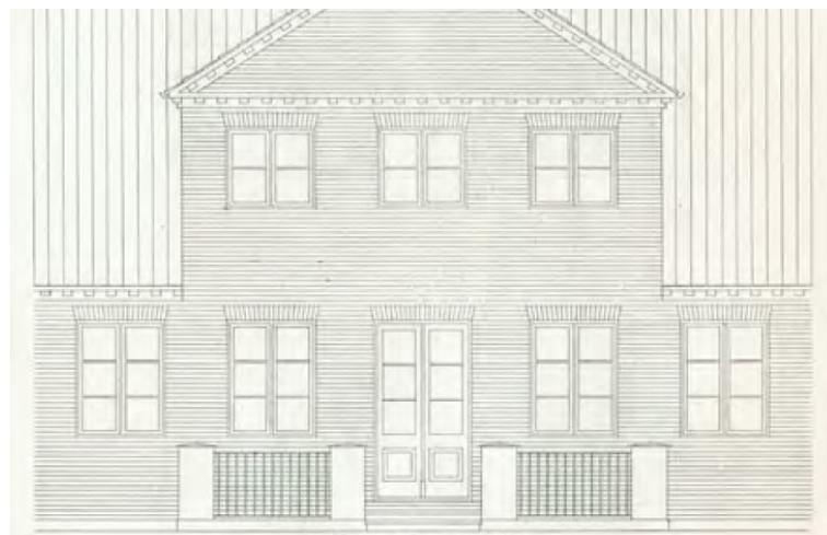
Eksempel på facade med åbninger, der har samme bredde, gennemgående murpiller (murstykket mellem åbningerne, lodret og vandret) og ens rudeformat. Stueetagens vinduer og hoveddør er træ ruder høje, og frontkvistens vinduer er to ruder høje. Billede fra Bevaringsguide for Bedre byggeskik.
