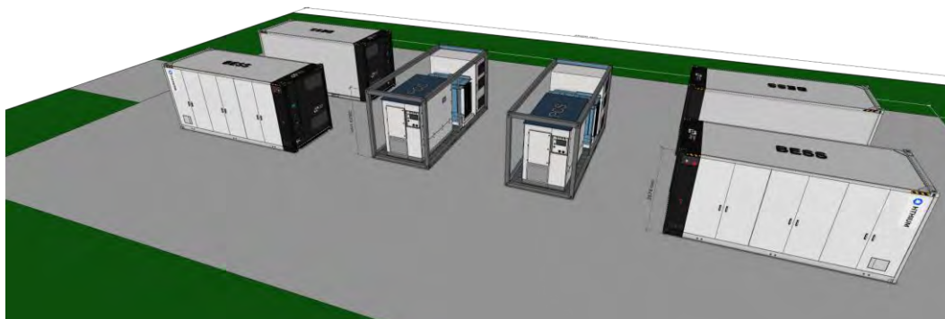
BESS-anlæg – Modulopbygning med battericontainere og invertere
