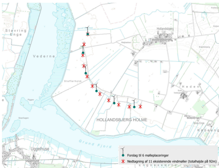
Kort 1, De 11 eksisterende vindmøller med en totalhøjde på 92 m fjernes (angivet med røde krydser), og erstattes med 6 nye vindmøller på samme buede spor som de eksisterende med en total højde på op til 185m (angivet med blå signatur).
