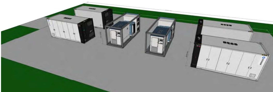
BESS-anlæg – Modulopbygning med battericontainere og invertere
